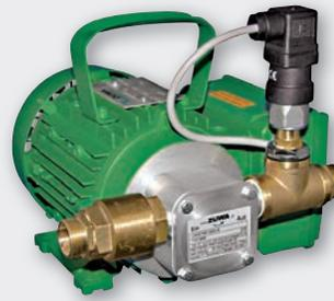
Der Druckschalter schaltet die Pumpe bei Erreichen eines voreingestellten Druckes ab. Sobald der Druck um 30% abfällt, schaltet sich die Pumpe automatisch wieder ein. (Nur für 400 V Pumpen)
